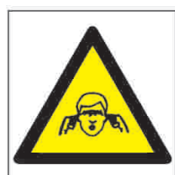
Ref. 332 Peligro de ruido
