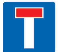
Ref. S-15-A Preseñalización de calzada sin salida
