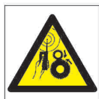
Ref. 308 Peligro maquinaria accionada a distancia
