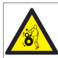
Ref. 377 Peligro Riesgo de atrapamiento
