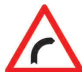
Ref. P-13-A Curva peligrosa hacia la derecha
