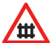
Ref. P-7 Paso a nivel con barreras
