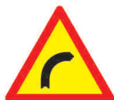
Ref. TP-13-A Curva peligrosa hacia la derecha
