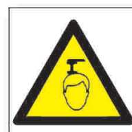
Ref. 398 Peligro Objetos fijos a baja altura
