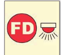
M006 ESPACIO PROTEGIDO CON ALARMA AUTOMÁTICA DE INCENDIOS
