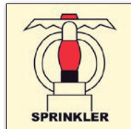
M009 ESPACIO PROTEGIDO POR SPRINKLERS
